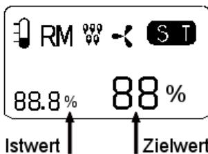
2. Sobald der Zielwert erreicht wird, schaltet das Gerät ab und das LED Licht wechselt von Grün auf Rot.
